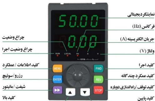
شکل ۳-۴ دیاگرام کنترل پنل
